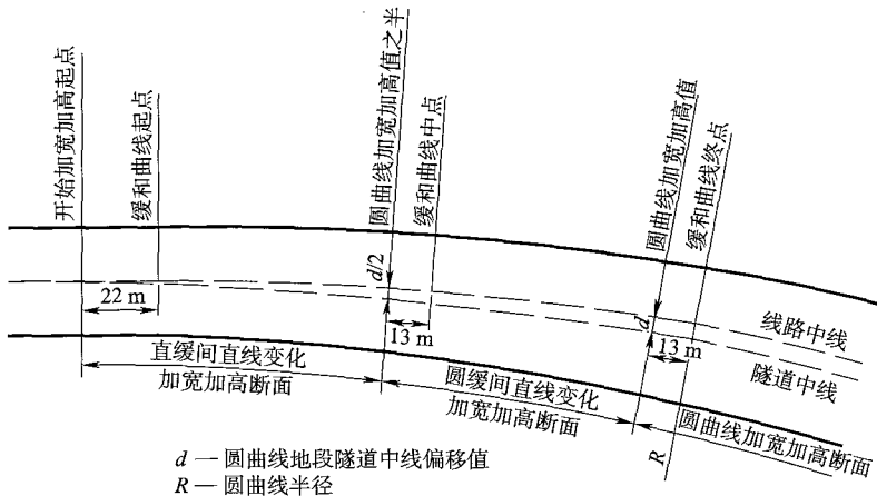
图 15.2.2 改建曲线地段隧道加宽加高示意图
